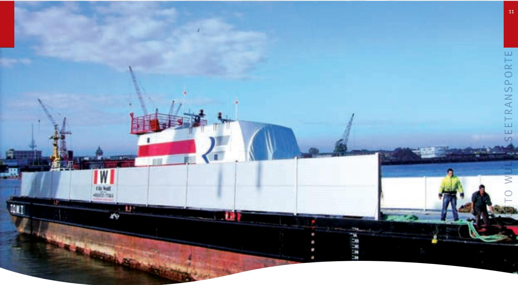
Ein zweites Spezialschiff ist unsere „Kugelbake“. Hierbei handelt es sich um einen 79 m langen, so genannten Deckcarrier ohne Laderaum, der auch im RoRo-Verfahren be- und entladen werden kann. Es wurde für den Transport von schwerer und großvolumiger Fracht entwickelt.
